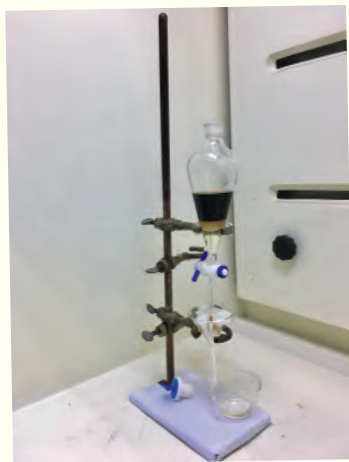
▲ Rozdzielacz – naczynie laboratoryjne służące do rozdzielania składników mieszanin
